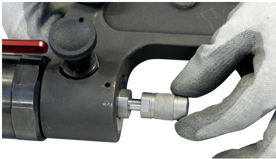
Atornillar la prolongación incluida con el brazo.
