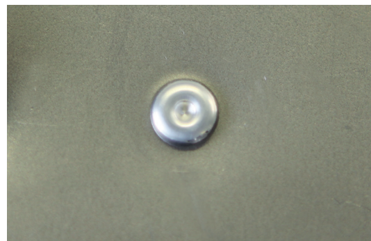
RÉSULTAT DE POSE D'UN RIVET FLOW-FORM
