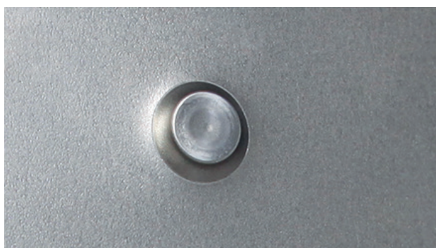
RÉSULTAT DE POSE D'UN RIVET AUTO-PERÇANT
