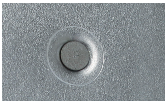
RÉSULTAT DE POSE D'UN RIVET AUTO-PERÇANT
