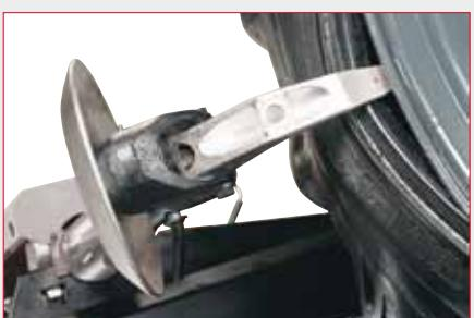
El soporte de la herramienta posee un **disco destalonador montado en casquillos autolubrificantes** que aseguran su durabilidad y fluidez de movimiento. El diseño particular del disco su inclinación de trabajo han sido desarrollados específicamente para permitir una óptima penetración entre el borde de la llanta y el talón del neumático. Además, el perfil exterior evita daños o bloqueos en el flanco del neumático
