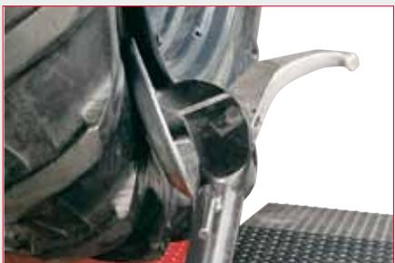
**fase de destalonadura del neumático**
