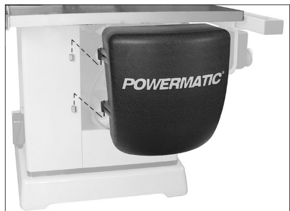
Figura 6-7: instalación de la cubierta del motor
